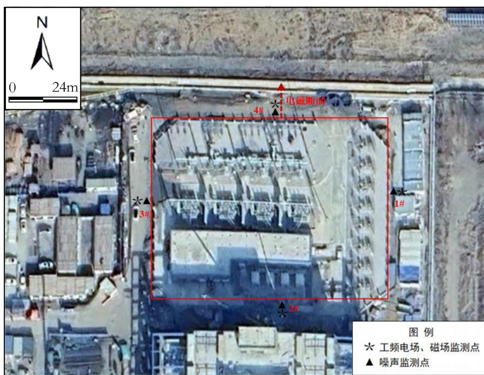
专题图 3 类比变电站电磁监测点位示意图
