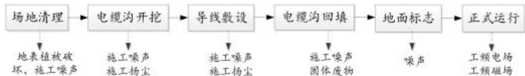
图 2-9 电缆施工工艺及产污环节
