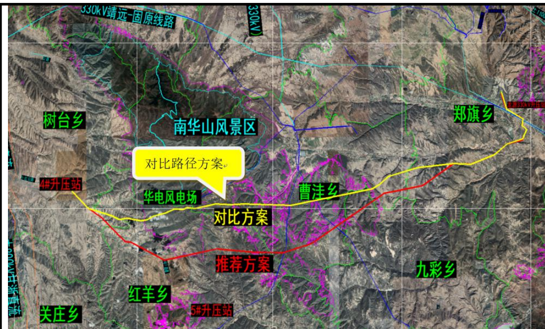
方案二：比选方案线路路径走向示意图（绿色为航空线，4#升压站为本次升压站）
